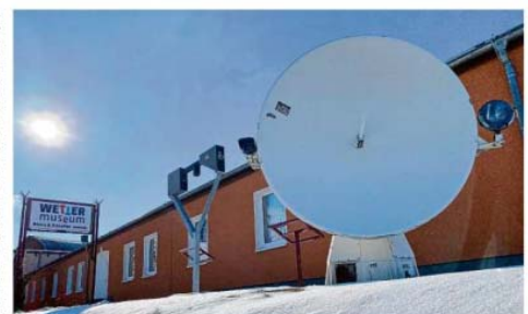
Neue Außenexponate: Mit dem Radargerät 300 WF wurde, bevor es die GPS-Technologie gab, die Position von Wetterballonen bestimmt. Der links daneben ausgestellte Streulichtschreiber MS05 ist ein Gerät zur Messung der Sichtweite, wie es in den 1980er Jahren zum Einsatz kam.
